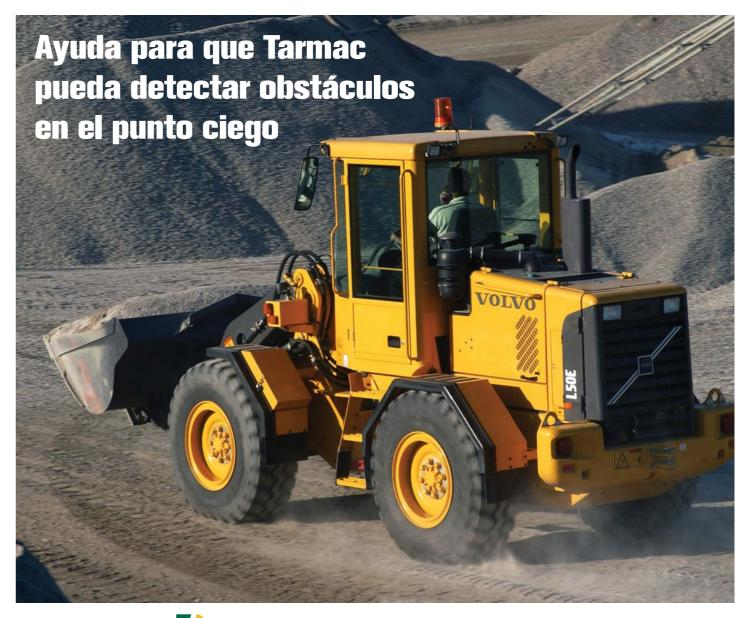
En las palas de carga y otras máquinas parecidas que se emplean en canteras y obras parecidas a menudo hay puntos ciegos que pueden ser peligrosos cuando el vehículo realiza maniobras. Los sistemas de vigilancia con cámaras pueden eliminar en gran medida esos puntos ciegos pero cuando el trabajo se realiza en condiciones de mala visibilidad, como con polvo espeso o durante la noche, el conductor no podrá ver objetos en su zona de peligro.
